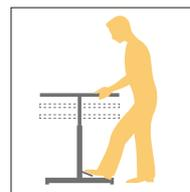
・ペダルを踏み、天板を持ち上げ用途に応じた高さに調整します。
